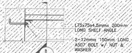
8A ELEVATION S-18 SCALE 1:10 M.
